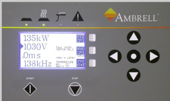
**EKOHEAT** è dotato di display con tastiera programmabile sul pannello anteriore per il monitoraggio, la regolazione del timer e della potenza, le informazioni di diagnostica e la configurazione di sistema. Possono essere preimpostati fino a a dieci profili di riscaldamento con fino a 10 fasi diverse di livello di potenza, per realizzare cicli di riscaldamento specifici e ripetibili.
