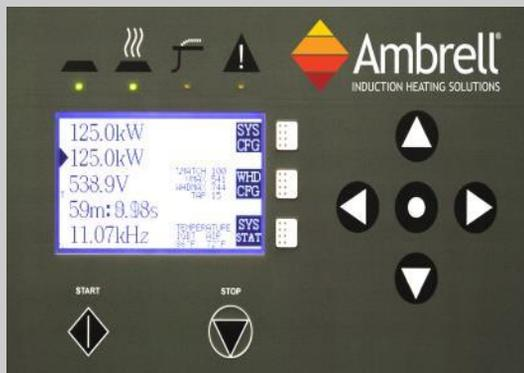
An der Vorderseite des EKOHEAT befindet sich ein programmierbarer Regler zur Überwachung, Timer- und Leistungsstufensteuerung sowie Diagnose und Systemkonfiguration. Es können bis zu 10 zehnstufige Erwärmungsprofile konfiguriert werden, um die Leistungsstufen entsprechend den vorgegebenen Zeitanforderungen zu steuern
