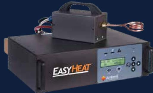
EASYHEAT weist an der Vorderseite einen programmierbaren Regler auf, mit dem bis zu 4 verschiedene Heizprofile mit jeweils bis zu 5 Zeit-/Leistungsstufen definiert werden können.
