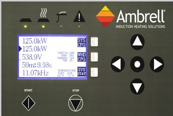
An der Vorderseite des EKOHEAT befindet sich ein programmierbarer Regler zur Überwachung, Timer- und Leistungsstufensteuerung sowie Diagnose und Systemkonfiguration. Es können bis zu 10 zehnstufige Erwärmungsprofile konfiguriert werden, um die Leistungsstufen entsprechend den vorgegebenen Zeitanforderungen zu steuern.
