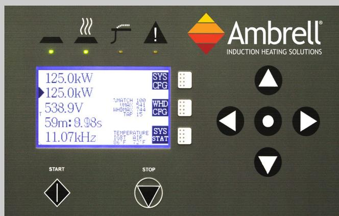
**EKOHEAT** cuenta con un controlador de panel frontal programable que facilita la supervisión del sistema, el control de la sincronización y el nivel de potencia, los diagnósticos y la configuración del sistema. Se pueden configurar hasta diez perfiles de diez fases de calentamiento para controlar los niveles de potencia durante las demandas de sincronización especificadas.
