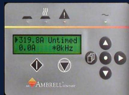
EASYHEAT weist an der Vorderseite einen programmierbaren Regler auf, mit dem bis zu 4 verschiedene Heizprofile mit jeweils bis zu 5 Zeit-/Leistungsstufen definiert werden können.
