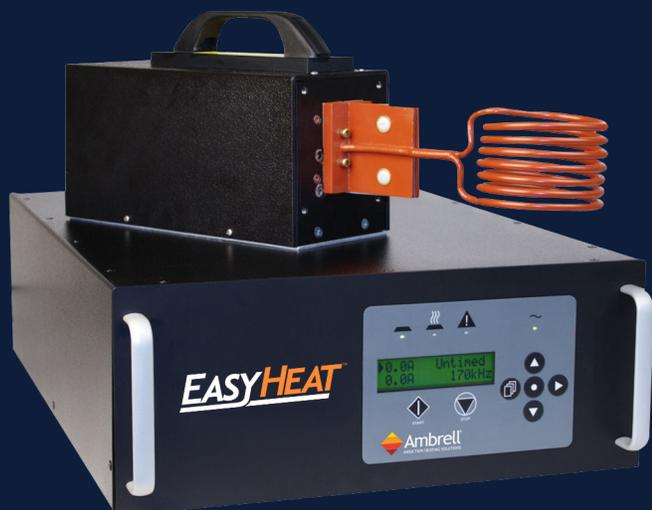
Os sistemas de aquecimento indutivo EASYHEAT constituem soluções confiáveis e compactas para o aquecimento eficiente de suas peças através de uma fonte de calor rápida e limpa, ideal para o aquecimento sem contato e repetível de suas peças. O cabeçote de trabalho móvel pode ficar localizado até 3 m (10 pés) da fonte de alimentação.
