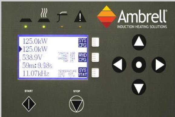
EKOHEAT comporte un panneau frontal avec une commande programmable pour la surveillance, le contrôle de la minuterie et du niveau de puissance, les diagnostics et la configuration du système. Jusqu'à 10 profils de chauffage en dix étapes peuvent être configurés pour contrôler les niveaux de puissance par rapport à vos exigences en matière de minuterie.
