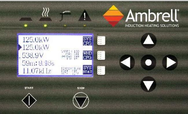
EKOHEAT cuenta con un controlador de panel frontal programable que facilita la supervisión del sistema, el control de la sincronización y el nivel de potencia, los diagnósticos y la configuración del sistema. Se pueden configurar hasta diez perfiles de diez fases de calentamiento para controlar los niveles de potencia durante las demandas de sincronización especificadas.
