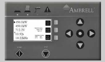
EKOHEAT è dotato di un controller programmabile sul pannello anteriore per monitoraggio, controllo del timer e del livello di potenza, diagnostica e configurazione del sistema. È possibile configurare fino a dieci profili di riscaldamento a 10 fasi per controllare i livelli di potenza rispetto ai propri specifici requisiti di timing.
