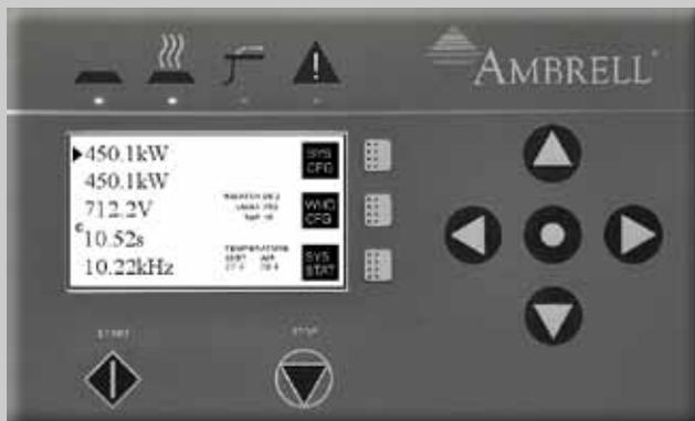
An der Vorderseite des EKOHEAT befindet sich ein programmierbarer Regler zur Überwachungs-, Timer- und Leistungsstufensteuerung sowie Diagnose und Systemkonfiguration. Es können bis zu 10 zehnstufige Erwärmungsprofile konfiguriert werden, um die Leistungsstufen entsprechend den vorgegebenen Zeitanforderungen zu steuern.
