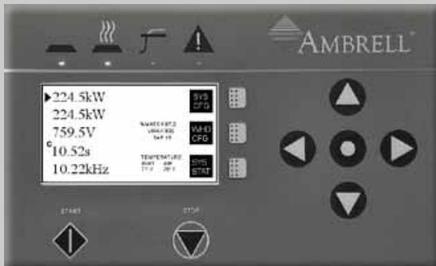
EKOHEAT cuenta con un controlador de monitor delantero programable que facilita la supervisión del sistema, el control de la sincronización y el nivel de potencia, los diagnósticos y la configuración del sistema. Se pueden configurar hasta diez perfiles de diez fases de calentamiento para controlar los niveles de potencia durante las demandas de sincronización especificadas.
