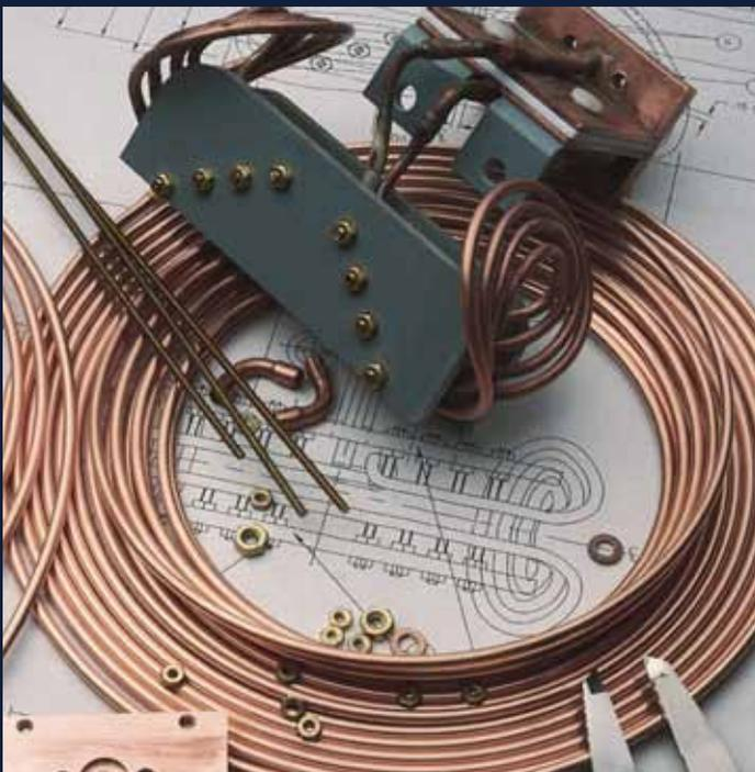
La bobine d'induction, ou inducteur, est le composant du système de chauffage par induction qui détermine l'efficacité et le rendement du chauffage de la pièce. La complexité des bobines est très variable, d'un simple enroulement hélicoïdal (solénoïde), formé d'un certain nombre de spires de tube de cuivre enroulées sur un mandrin, aux bobines de précision usinées en cuivre massif et brasées.
