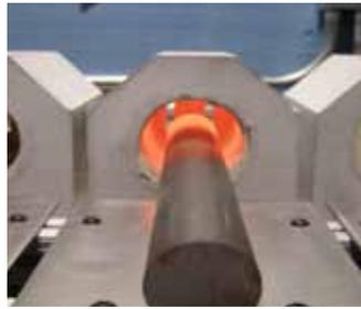
Une fois les bobines conçues et leur zone de chauffage démontrée, elles sont souvent enrobées afin de les isoler thermiquement du processus et d'accroître leur résistance dans les environnements difficiles. Les matériaux d'enrobage habituels sont le béton, la céramique, la résine époxy et les thermoplastiques.
