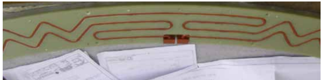
Bobina montada debajo de un transportador para calentar latas metálicas.
