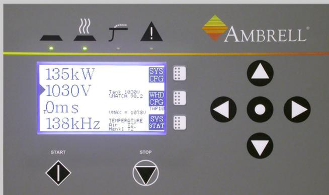
EKOHEAT è dotato di display con tastiera programmabile sul pannello anteriore per il monitoraggio, la regolazione del timer e della potenza, le informazioni di diagnostica e la configurazione di sistema. Possono essere preimpostati fino a dieci profili di riscaldamento con fino a 10 fasi diverse di livello di potenza, per realizzare cicli di riscaldamento specifici e ripetibili.
